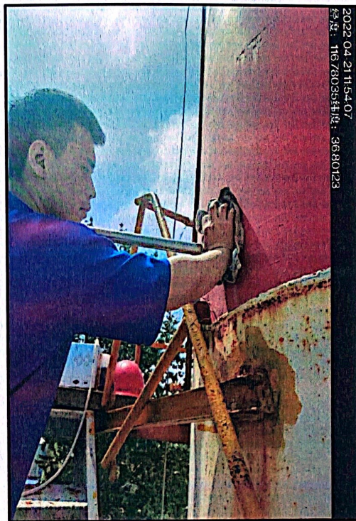
附图 2: 喷漆工序处理设施后废气采样
